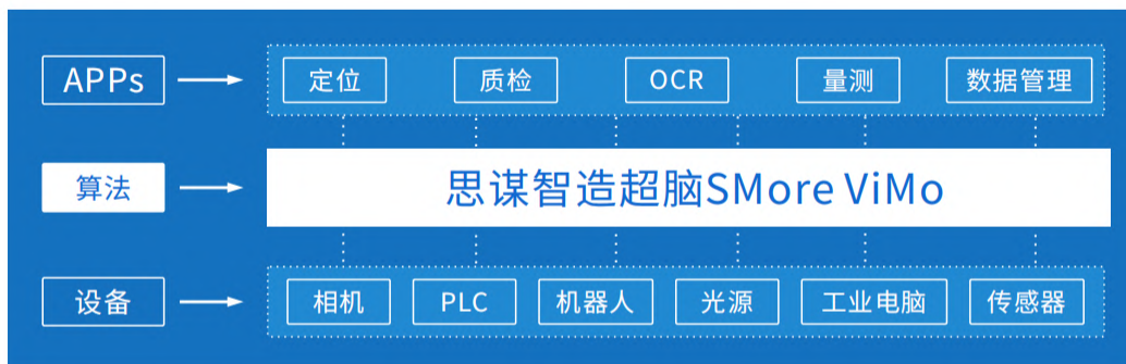
图2 轴承AI视觉检测整体解决方案架构(来源:中国信通院-工业互联网资源池)
