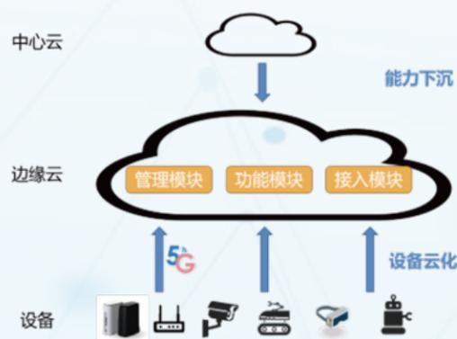
图2-2 云化设备架构
